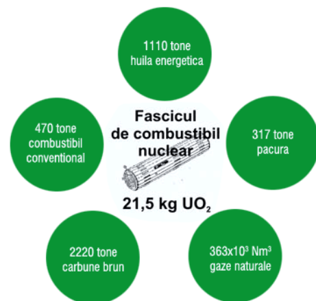
Fig. 3.5. „Arderea” unui fascicul de combustibil
