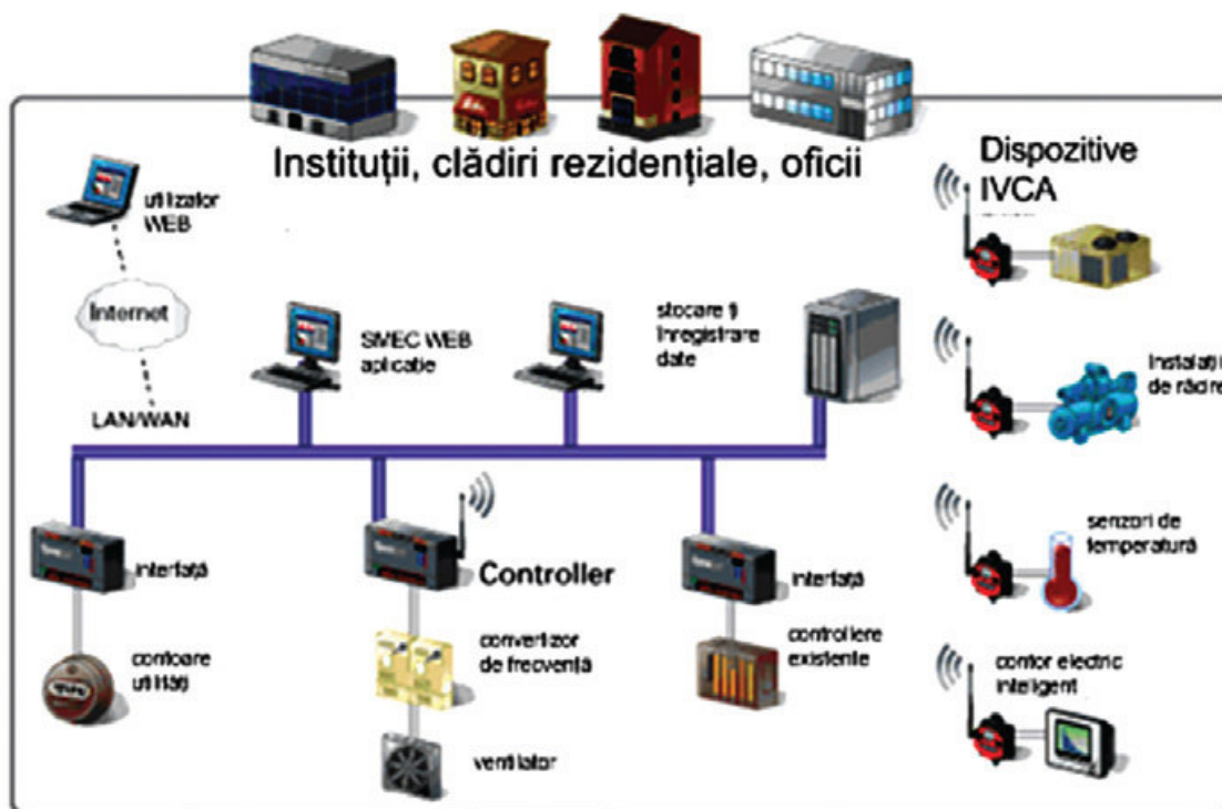
Figura 6.20. Componentele și funcțiile sistemului de management al energiei în clădiri - SMEC (sursa: www.poweritsolutions.com ).
