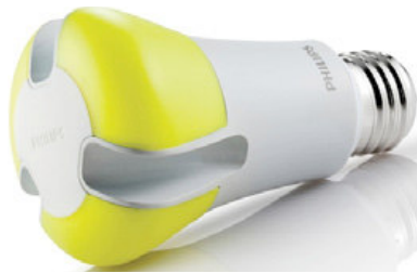
Figura 6.18. Lampă LED, considerată de către Departamentul SUA pentru Energie ca fiind lampa cea mai eficientă și care furnizează lumină de cea mai înaltă calitate. Aceasta este o lampă de 10 watt care asigură o cantitate de lumină similară cu lampa incandescentă de 60 watt. (sursa: Phillips)
