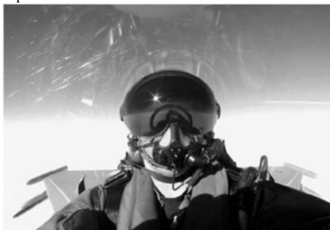
Fig. 18. Cască cu display pe vizieră, utilizată de piloți de pe avionul supersonic Eurofighter
