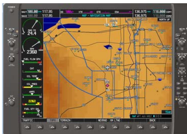
Fig. 21. MFD cu vizualizarea parametrilor motorului și harta
