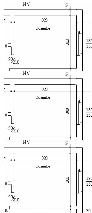
55. Pentru o încăpere, având înălțimea de 2,50 m, aflată într-o casă de locuit fără pod, neadăpostită, cu ferestre duble, amplasată într-o localitate din zona a IV-a climatică (figura alăturată), necesarul de căldură este:
