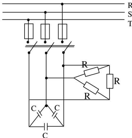
Fig.11.12. Conectarea în triunghi a rezistenței de descărcare
