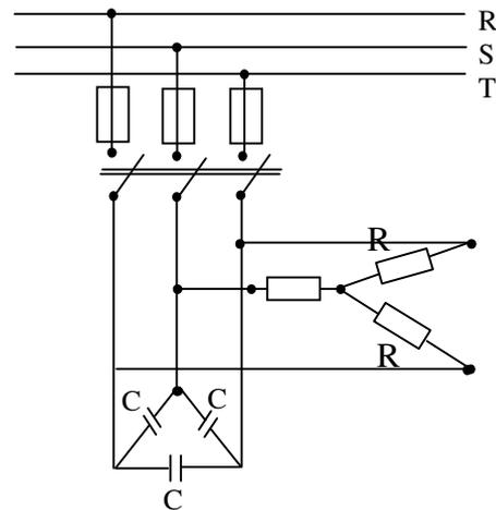
Fig.11.13. Conectarea în stea a rezistenței de descărcare
