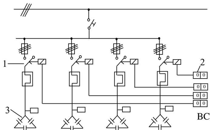
Fig.11.10. Comutare manuală a treptelor bateriei de condensatoare
