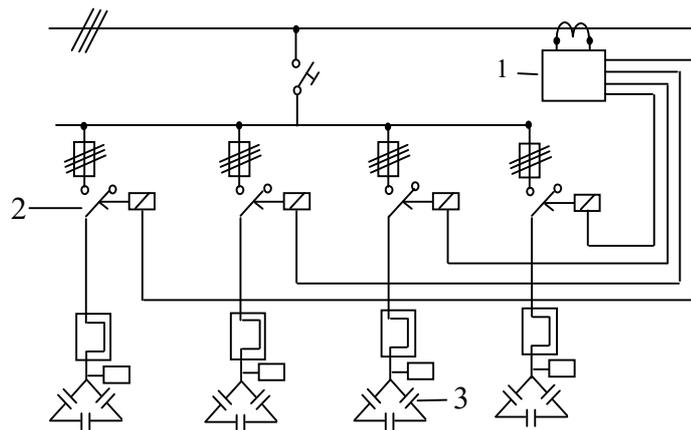
Fig.11.11. Comutare automată a bateriei de condensatoare
