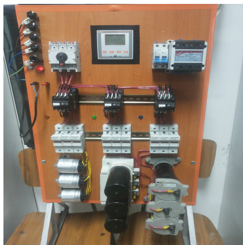
Fig. 5 . Platforma de studiu al factorului de putere
